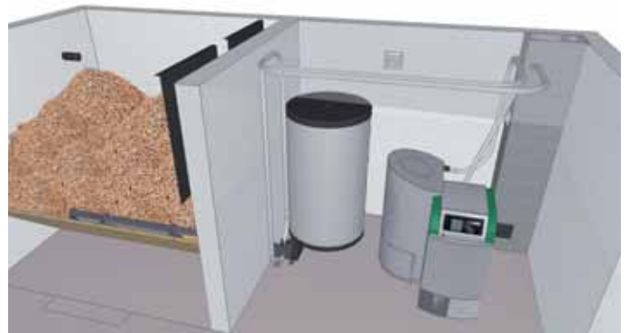
Extraction de silo par vis sans fin combinée à un système d'aspiration
