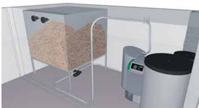
Extraction de silo tissu par système d'aspiration
