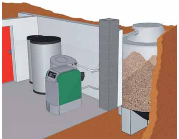
Extraction de silo enterré par système d'aspiration
